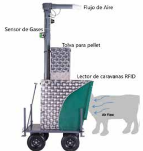
Figura 1. Esquema del funcionamiento de la unidad GreenFeed (C-Lock, Inc.) para monitorear emisiones de gases.
