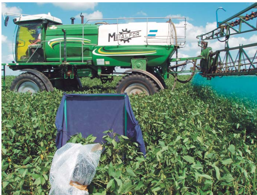
Figura 20. Pulverizador utilizado y montaje de cámara de filmación.
