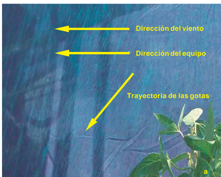
Figura 21. Trayectoria de las gotas con boquillas AI110015, orientación vertical. a) visualización, b) modelación.
