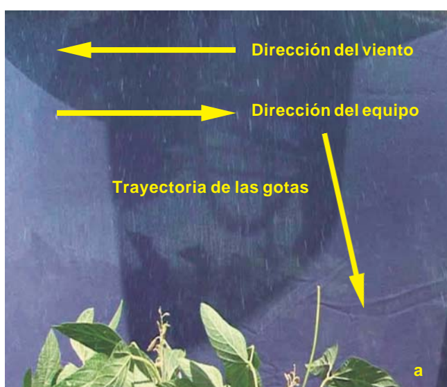
Figura 22. Trayectorias con boquillas AI, orientación 45°; a) visualización, b) modelación.
