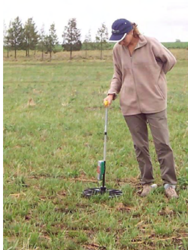
Figuras 3 y 4. Registración de medidas con el RPM (izquierda) y corte de muestras para muestreos de materia seca (derecha) para la calibración del RPM.
