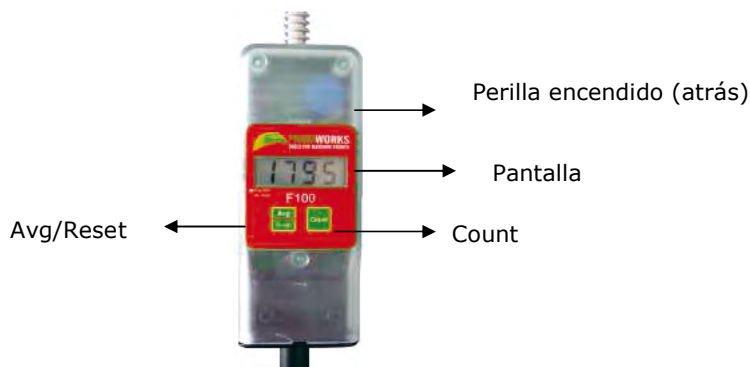
Figura 2. Dispositivo electrónico del RPM.
