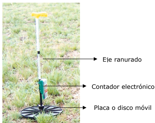
Figura 1. Representación esquemática del RPM.
