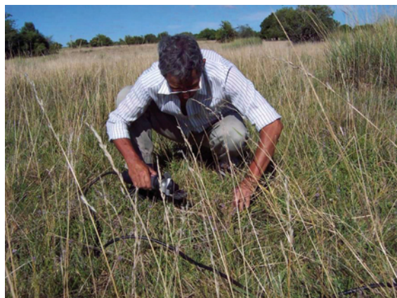
Figuras 3 y 4. Registración de medidas con el RPM (izquierda) y corte de muestras para muestreos de materia seca (derecha) para la calibración del RPM.
