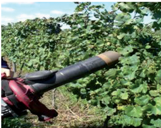
Figura 107. Equipo de succión utilizado para el muestreo de artrópodos aéreos. Los artrópodos son colectados dentro de un tubo de poliamida ubicada en el extremo distal del equipo.
