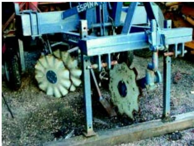
Figura 1 - Equipo de mínimo laboreo constituido por una cuchilla dentada cortadora, un subsolador con pata de ganso, dos juegos de discos ravioleros y un rodillo.
