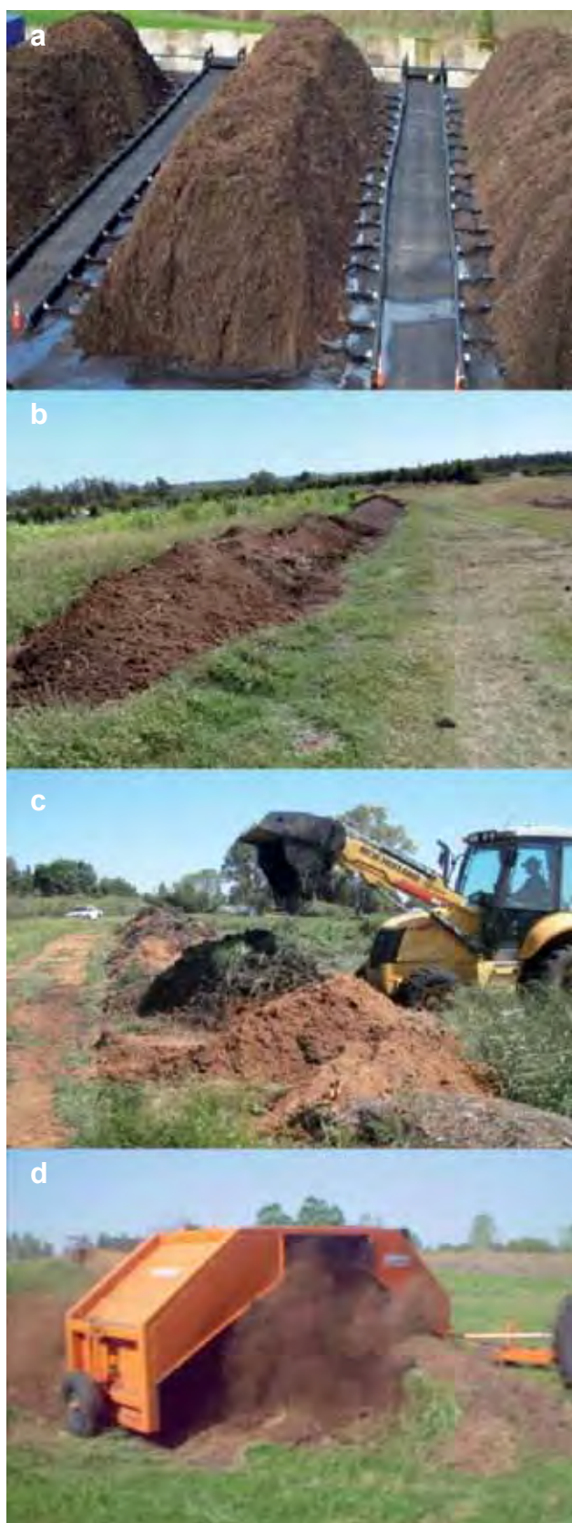
Figura 2 - Sistema de compostaje a campo en pila o hilera. (a) Pila estática con aireación forzada. (b) Pila estática con volteo manual o mecánico. (c) Volteo con tractor con pala frontal. (d) Volteo con compostador.
