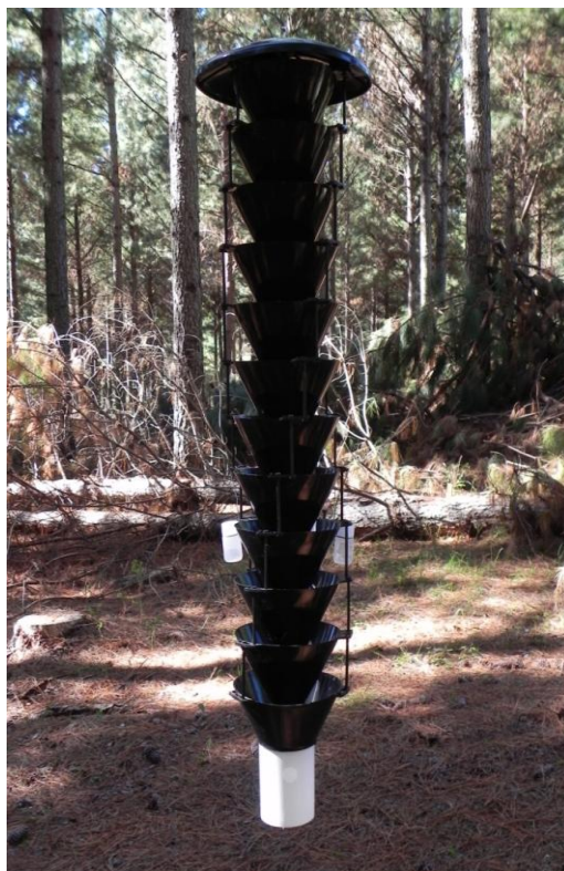
Figura 21. Trampa Lindgren de 12 embudos colgada en la entrefila de una plantación de P. taeda .
