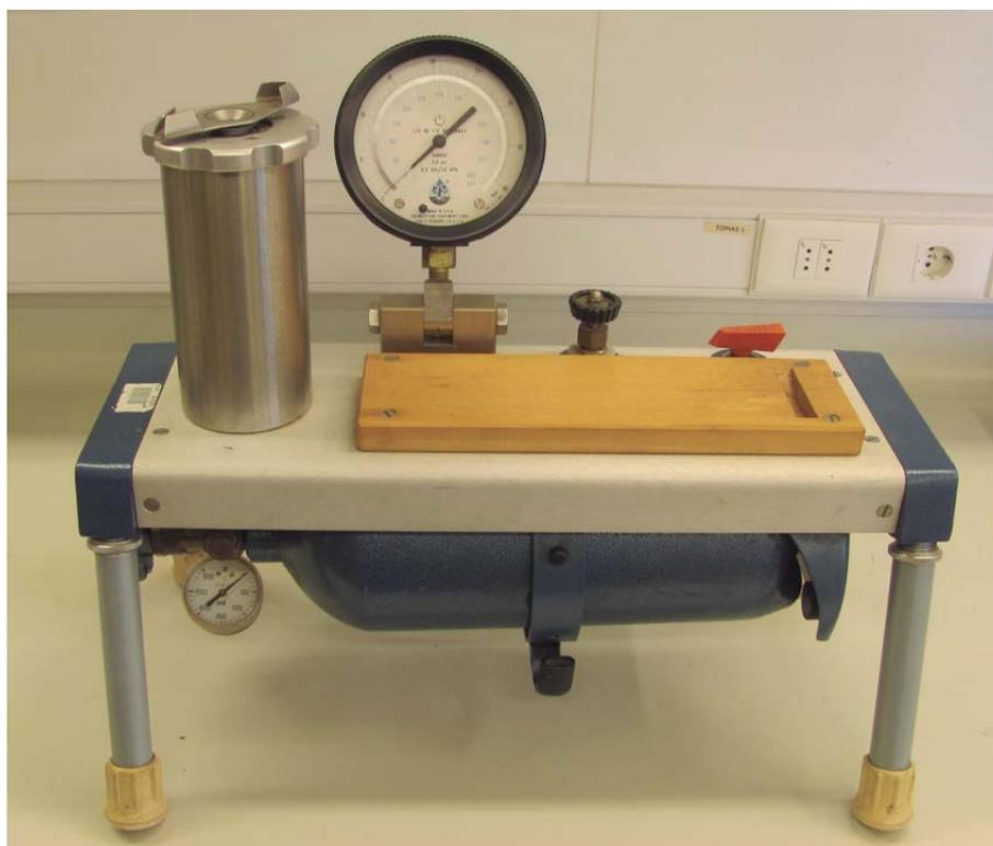
**Figura 6.** Cámara de presión tipo Sholander (Soilmoisture, USA)
