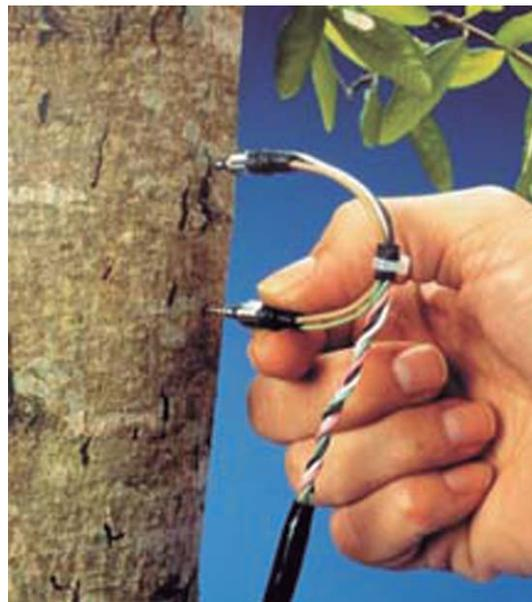
**Figura 8.** a) Sonda de balance térmico de tallo (Dynamax); b) Sonda de disipación de calor (Dynamax).
