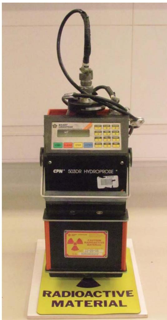
Figura 5. Sonda de neutrones, CPN (USA)
