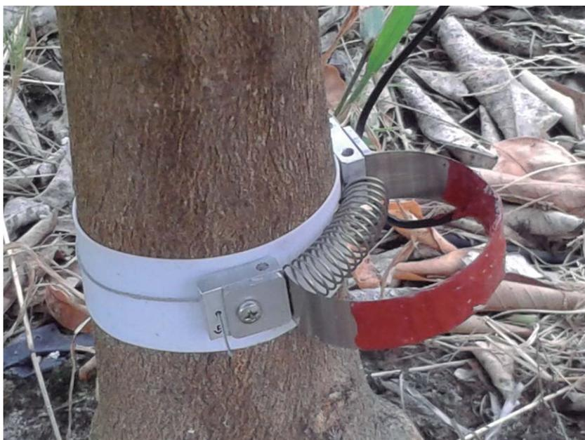
Figura 7. Dendrómetro en tronco de cítricos (D6, UMS).
