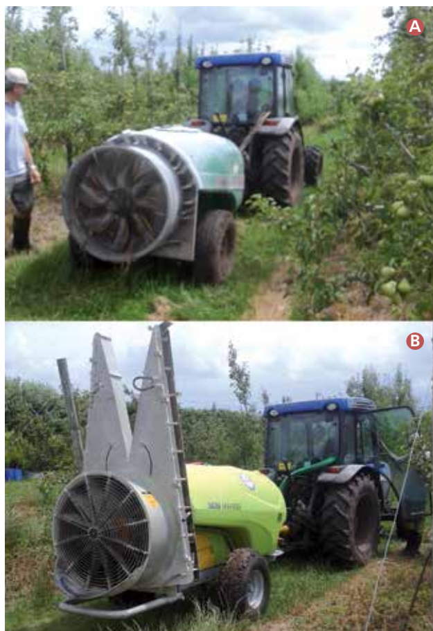
Figura 1 - Imágenes de los equipos pulverizadores A) equipo pulverizador de flujo axial, B) equipo pulverizador de flujo tangencial.
