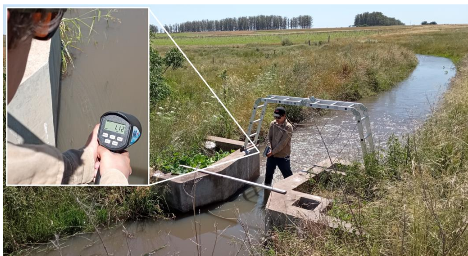
Figura 2. Canal aforador de garganta cortada de la represa Buena Vista y medición de la velocidad superficial por medio de radar
