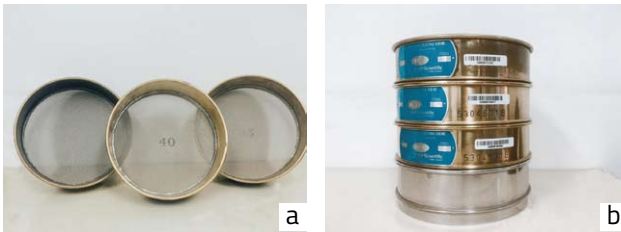
Fig.33. Modelos de tamices: a) unidades simples, b) conjunto para tamizaje vertical. LSF. INIA – Tacuarembó.
