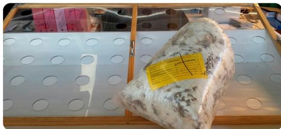
Por sobre la muestra abierta y expandida homogéneamente se coloca una placa de acrílico que posee 60 agujeros distribuidos a distancias iguales desde donde serán extraídas las mechas a analizar. De esta forma se obtienen en forma aleatoria las mechas a ser analizadas. Es imprescindible que el muestreo de mechas se realice en conjunto y previamente al muestreo por caladuras, manteniendo la trazabilidad entre ambos tipos de muestras.
