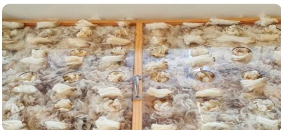
**Es imprescindible que el muestreo de mechas se realice en conjunto y previamente al muestreo por caladuras, manteniendo la trazabilidad entre ambos tipos de muestras. Los resultados de Core Test deben ser utilizados para determinar la resistencia a la tracción.**
