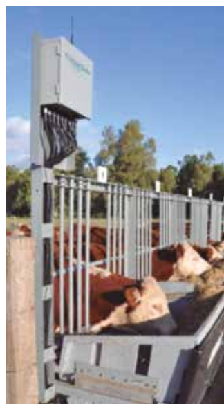
Figura 2. Comederos automáticos para la medición de consumo individual de alimento.
