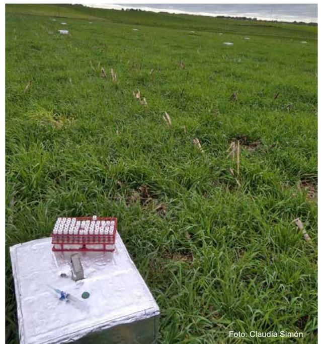
**Figura 9** - Las mediciones de las emisiones de óxido nítrico (N<sub>2</sub>O) se realizaron instalando ocho cámaras estáticas de flujo cerrado en cada parcela de los tratamientos medidos en el experimento de Largo Plazo de Rotaciones de La Estanzuela.
