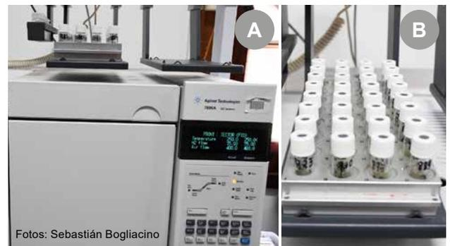
**Figura 8** - Equipo de cromatografía de gases para el análisis de la concentración del gas óxido nitroso (A). Detalle de las bandejas del cromatógrafo con los viales con muestras del campo que serán analizadas (B).
