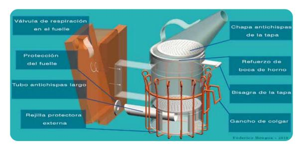
Todas las piezas del ahumador deben estar en buenas condiciones y para ello esta herramienta debe someterse a un mantenimiento periódico. En particular la tapa debe cerrar con firmeza, sus partes deben estar bien ajustadas y debe deshollinarse periódicamente.
