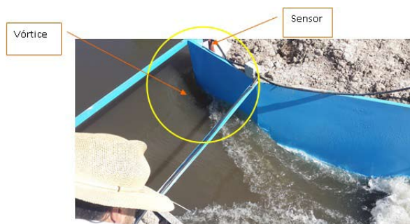
Figura 5-1 Vórtice generado en la zona del sensor. SC 16
