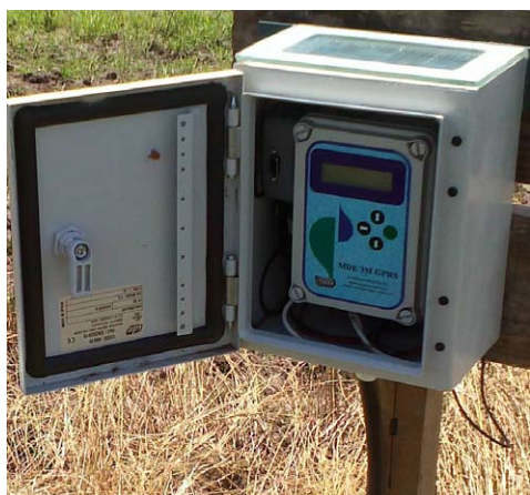
Figura 4-35 Gabinete con Panel solar integrado de Acequia Innova
