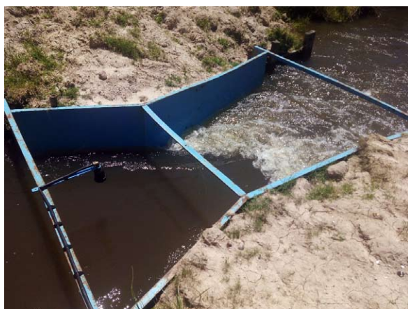
Figura 5-3 Sin Cuello 24 con sensor electroacústico (ESPAY-gprs Eco)
