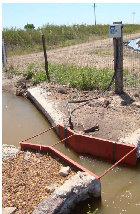
Figura 5-5 Sin Cuello 11 con doble sensor
