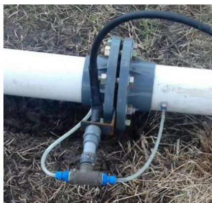
Figura 4-5 Placa Orificio con sensor hDif de carga Acequia Innova
