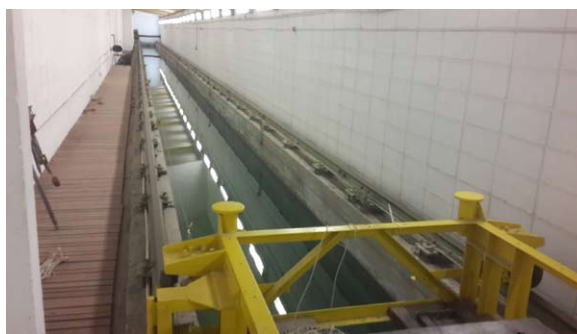
Figura 4-32 IMFIA Calibración correntómetros en canal de flujo laminar
