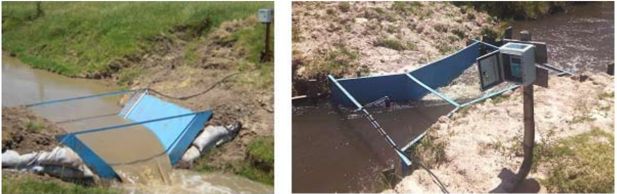
Figura 4-13 Izquierda, aforador ACA instrumentado con ESPAY-gprs con sensor piezo-resistivo. Derecha, aforador sin cuello N° 24 instrumentado con ESPAY-gprs con sensor electroacústico (Eco ultrasonido)
