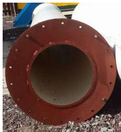
Figura 4-27 Fabricación de Placa de Orificio en chapa
