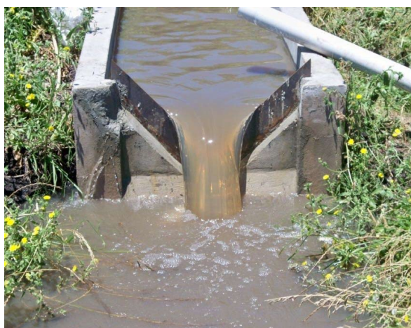
Figura 5-6 Vertedero triangular de 90°
