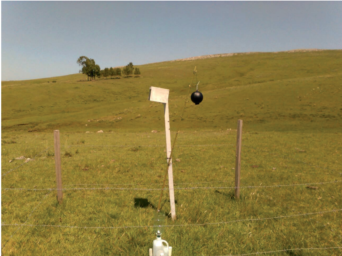
Vista panorámica del set de instrumental meteorológico instalado bajo monte y fuera de monte (casilla meteorológica, globo negro y pluviómetro).
