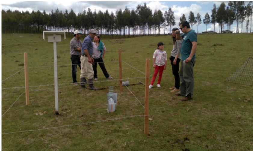
Vista del proceso de instalación del set de instrumental meteorológico, casilla meteorológica con sensor de temperatura del aire y globo negro.
