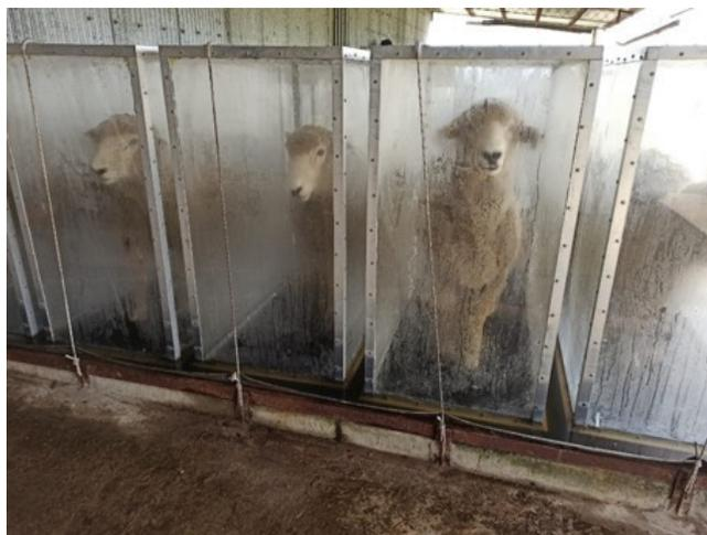
Figura 2. Cámara de Acumulación portátiles para la medición de emisiones gases de efecto invernadero.
