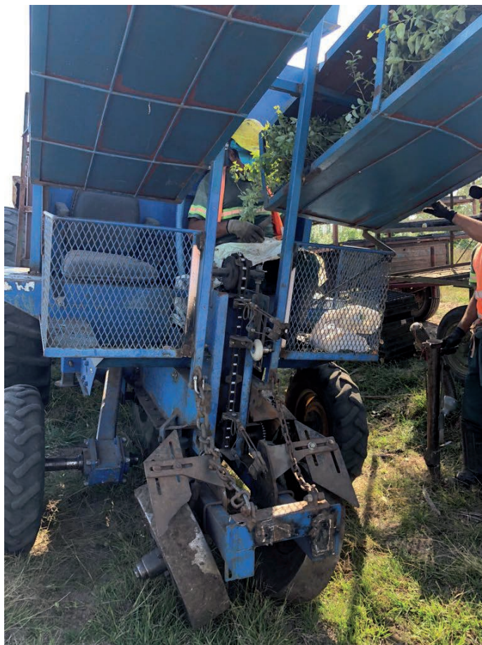
Figura 16. Plantación mecanizada con maquina plantadora. Fuente: Cortesía de Algorta, 2019.
