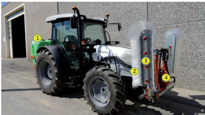
Figura 24. Aplicación de herbicida con pantalla protectora, para evitar dañar las plantas en la línea de plantación.
