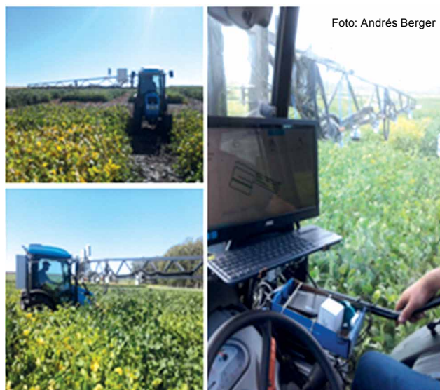
Figura 4 - Tractor adaptado con sensores espectrales relevando parámetros de comportamiento fisiológico en parcelas de soja a campo con o sin déficit hídrico.
