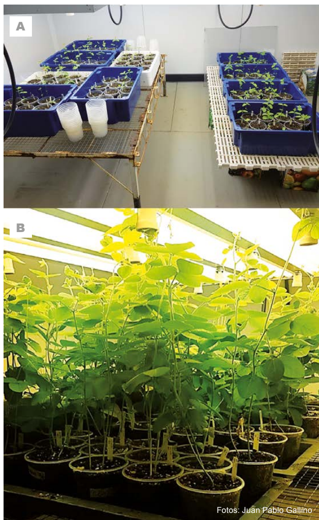
Figura 2 - Cámara de cría utilizada para el AGR. A) La capacidad actual es de 100 plantas. El uso de plafones montados en poleas permite una fácil adecuación de la cantidad de luz suministrada durante el ciclo de crecimiento. B) Plantas de soja de los genotipos estudiados creciendo en las condiciones detalladas.
