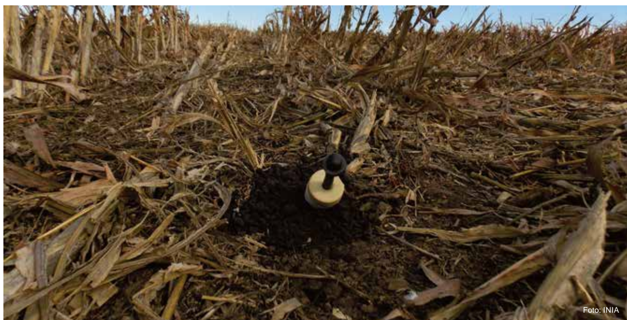
Figura 3 - Copa porosa de succión instalada a 60 cm de profundidad para medir pérdida de nitrógeno del suelo.
