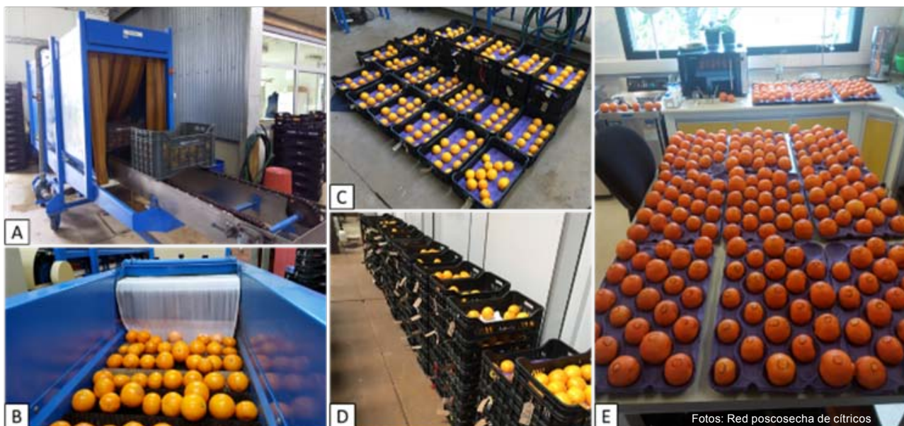
Figura 6 - A) Realización de ensayos en el drencher y B) en la cascada de la línea con fines de investigación instalada en INIA Salto Grande; C) y D): frutos con diferentes tratamientos de una evaluación de recubrimientos, dispuestos en cajas individuales y prontos para ingresar en cámaras de frío en INIA Salto Grande; E) evaluación de un ensayo de productos alternativos promisorios para el control de la podredumbre amarga realizado en el laboratorio de fitopatología de INIA Salto Grande.
