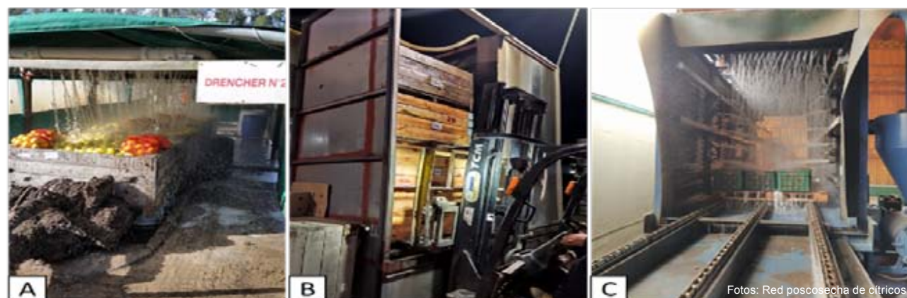
Figura 2 - A) Diferentes tipos de drencher utilizados por las empresas para realizar el primer tratamiento fungicida de poscosecha: drencher horizontal o “de fosa” instalado en el campo y B) drenchers verticales instalados en las plantas de empaque “de ropero” o C) de cadenas.
