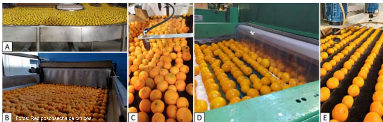
Figura 3 - A) Diferentes puntos de aplicación utilizados en las líneas de empaque de frutos cítricos: balsa con aplicación de hipoclorito de sodio; B) cortina de espuma donde generalmente se aplica jabón neutro con SOPP; C) módulos de aplicación acuosa utilizados para diferentes fungicidas, por aspersión o spray, D) o mediante cascada; E) módulo de aplicación de cera a la cual también se le agregan productos fungicidas, en este caso corresponde a una aplicación con dos sistemas de rotor.
