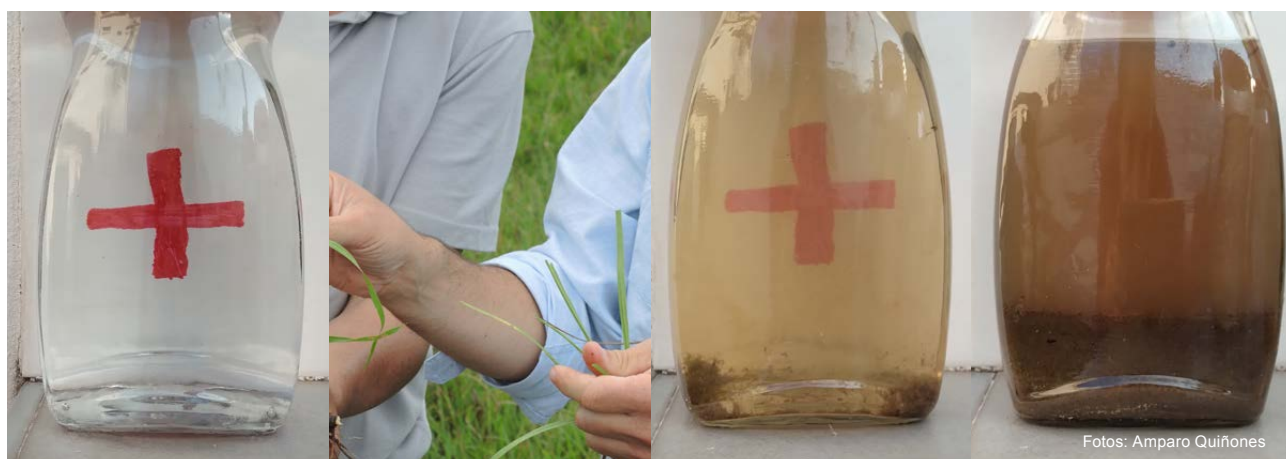
Figura 2 - Evaluación visual de la turbiedad de diferentes fuentes de agua.
