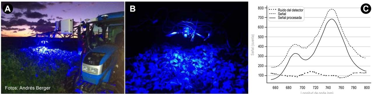
**Figura 5** - Tractor con luces monocromáticas azul, para la inducción de fluorescencia previo a la toma de mediciones (A). Luces y sensores durante la toma de mediciones (B). Señal de fluorescencia detectada luego de procesada la señal del sensor (C).
