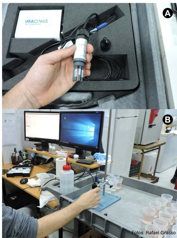
**Figura 2** - A) Sensor IMACIMUS; B) Medición de solución con IMACIMUS.
