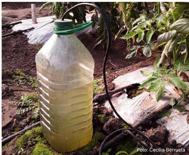
Figura 3 - Gotero de control para la colecta de SN.
