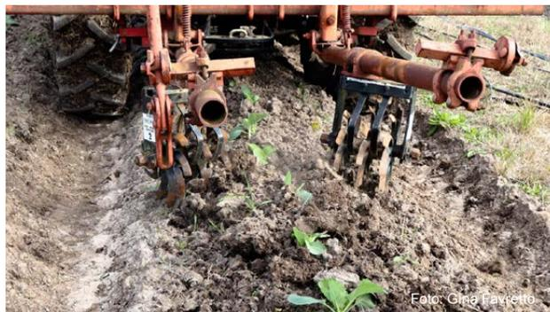
**Figura 2** - Pasada de discos rotatorios (disco de estrellas o rodillo de púas) a los costados para eliminar malezas en los costados de los canteros.
