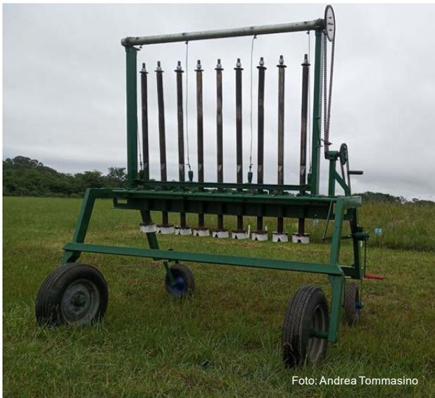
**Figura 2** - Dispositivo mecánico de simulación del pastoreo.
