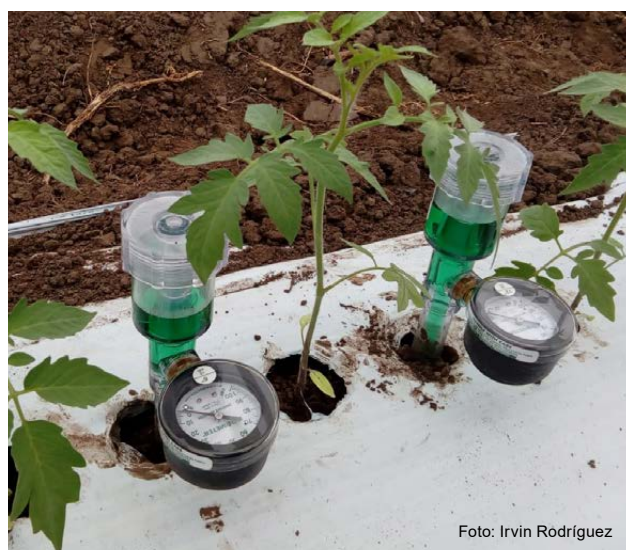
Figura 5 - Uso de tensiómetro en cultivos de tomate para el monitoreo de la humedad de suelo en la rizósfera.
