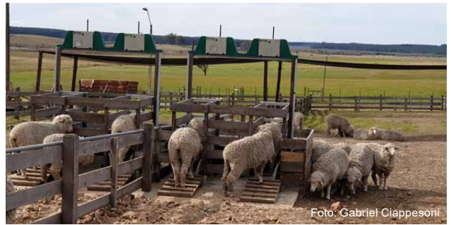
Figura 3 - Plataforma de fenotipado intensivo para ovinos en INIA La Magnolia: pesaje automático cuando los animales van a tomar agua.
