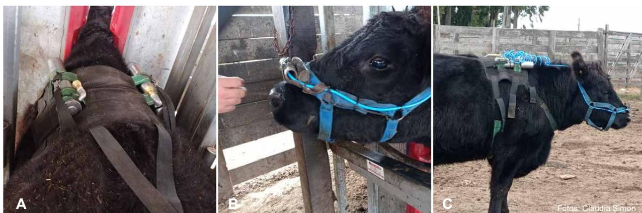
**Figura 2** - Equipo de medición: A) Tubos de acero inoxidable y mochila de sostén; B) Manguera de flujo controlado y arnés de sujeción; C) Novillo con equipo completo de medición de metano (CH<sub>4</sub>).
