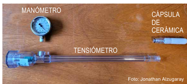
Figura 1 - Partes de un tensiómetro.
