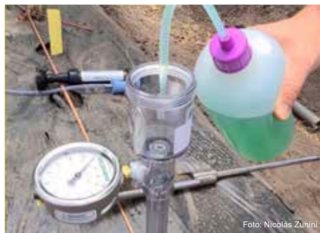
Figura 3 - Llenado del cuerpo del tensiómetro con solución alguicida y colorante.
