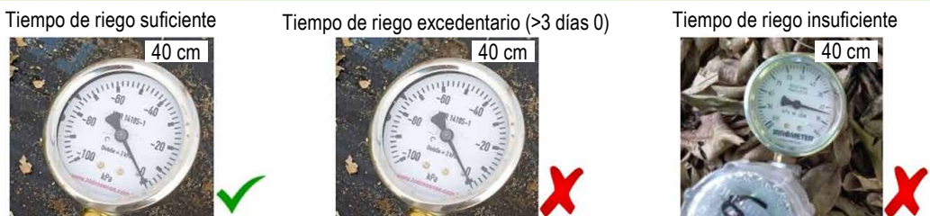
Figura 7 - Ejemplo de toma de decisiones de riego en base a tensiómetros.
