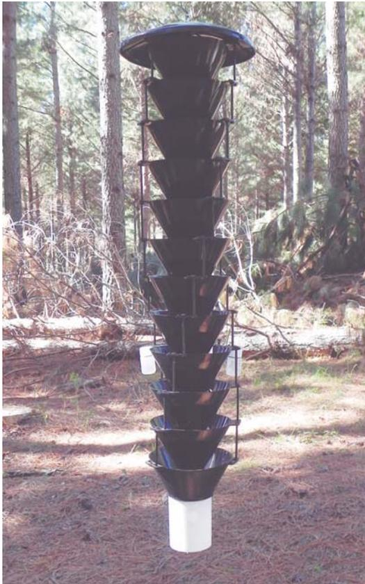
**Figura 1.** Trampa Lindgren de 12 embudos colgada en la entrefila de una plantación de *P. taeda*.
