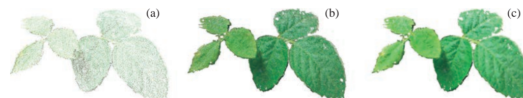
Figura 2. Inferindo superfícies a partir de nuvens de pontos. Nuvem de pontos produzida por SfM e MVS (a). Malha triangular produzida pelo algoritmo ball pivoting (b). Visualização da superfície suavizada (c).
