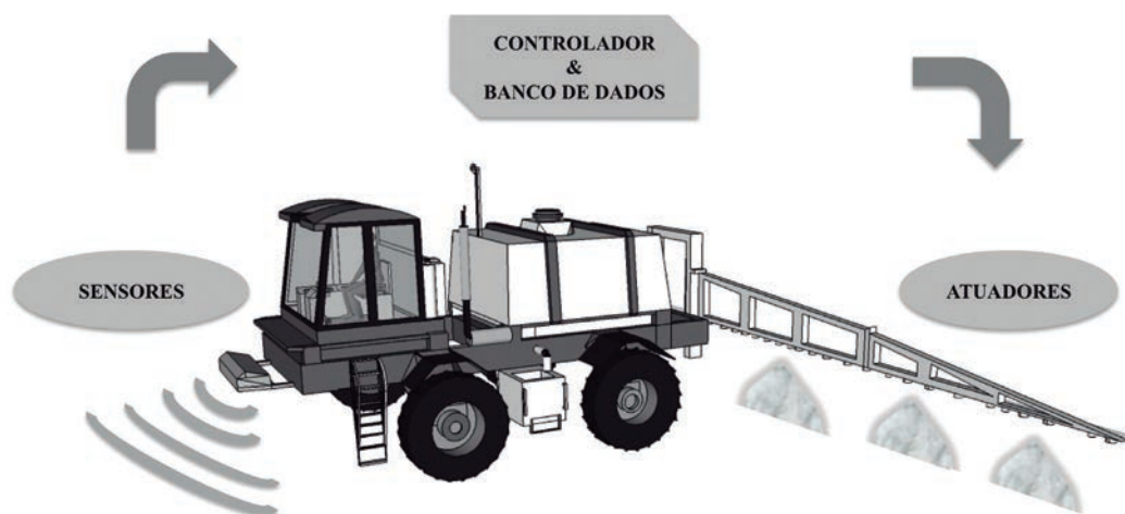
Figura 1. Sistema de sensoriamento e aplicação On-The-Go .
