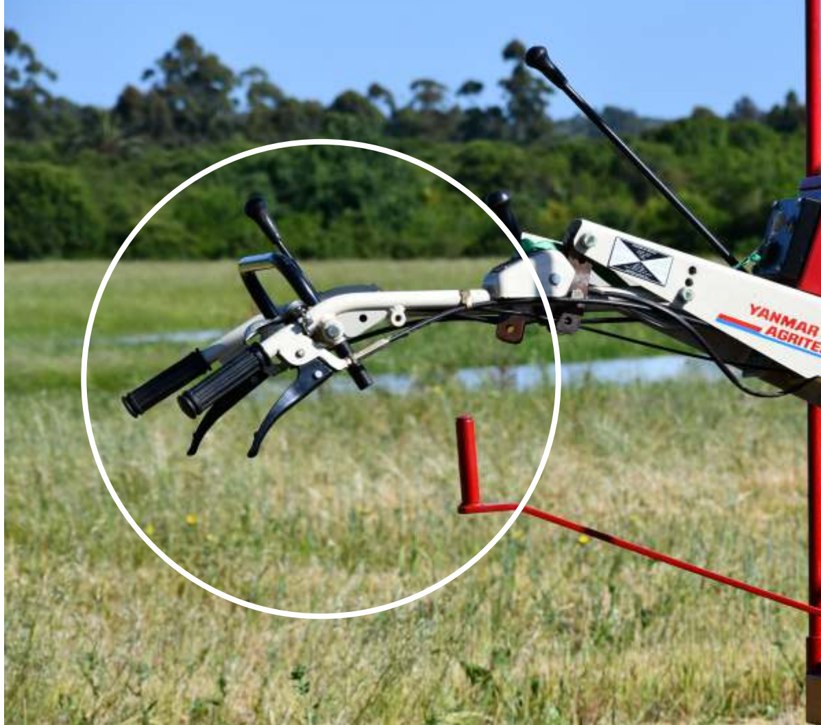
Mecanismo de dirección (palanca de cambio y palanca de dirección)
