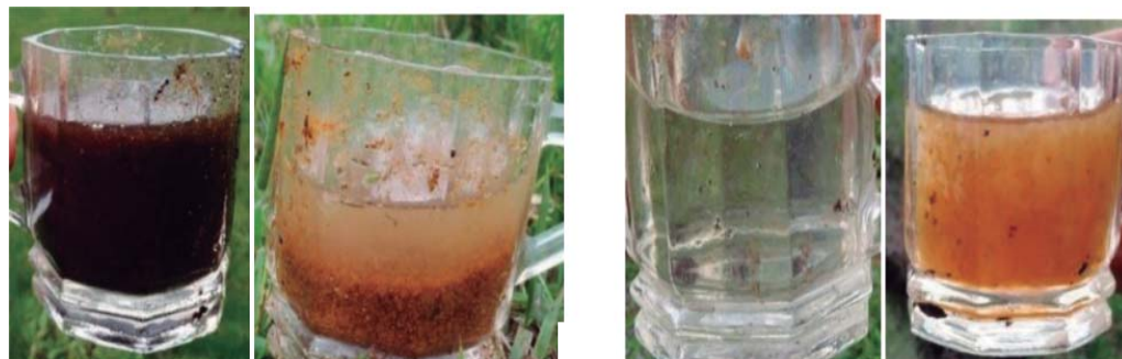
Foto 7. Agua surgente en ambiente bajo extraída (mayo 2016) de proximidades de parcela 318 (rendimiento 67 m 3 /ha): agua oscura con materia orgánica pH 7,74 CE 0,45 dS/m, T°C 13,5 y color rojo, rica en óxidos de Fe, pH 6,9, CE 0,3 dS/m, T°C 14 (extraída a un metro de distancia entre si) y en proximidades de parcela 320 (rendimiento 18 m 3 /ha), agua en superficie limpia, pH 8,05, CE 0,22, y 14,6°C y agua roja, pH 6,8, CE 0,17, y 13,0°C (Tabla 17)
