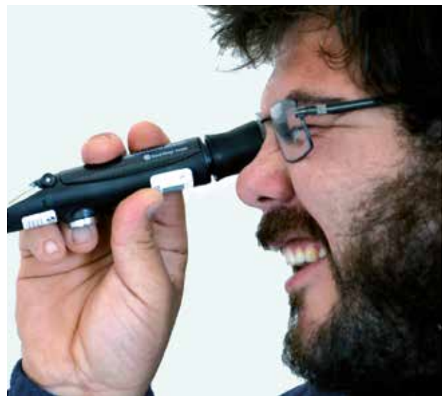
Figura 7 - Uso de un refractómetro óptico para evaluar el nivel de sólidos/proteínas totales, como método indirecto para determinar la eficacia de la transferencia pasiva de inmunidad.
