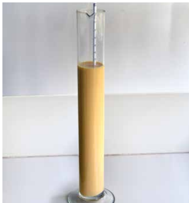
Figura 1 - Densímetro sumergido en una probeta que contiene calostro, como método de evaluación de su calidad.
