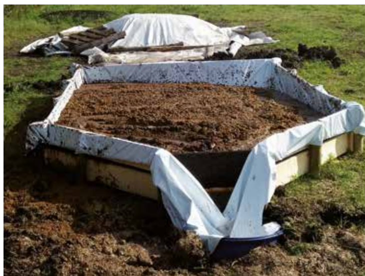
Figura 2 - Pretratamiento para disminuir a humedad escala piloto (superficie 6,25 m 2 para 1,5 m 3 de alperujo)
