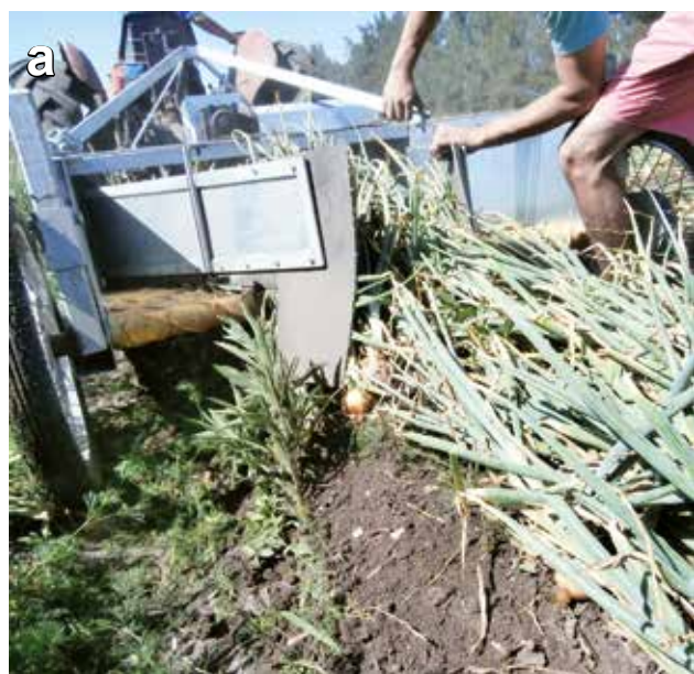
Figura 1 - (a) Arrancadora de cebolla adquirida en convenio DIGEGRA-INIA; (b) Sistema de arranque, elevación y limpieza.
