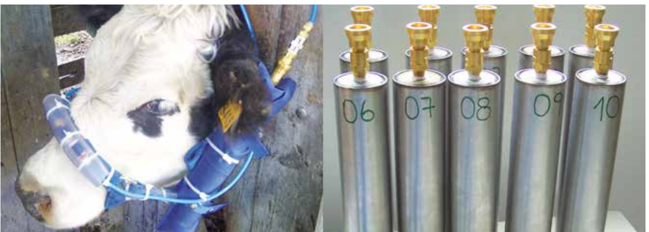
Figura 4 - Detalles de los tubos colectores del gas exhalado y eructado por el vacuno colocados a cada lado de la cabeza.
