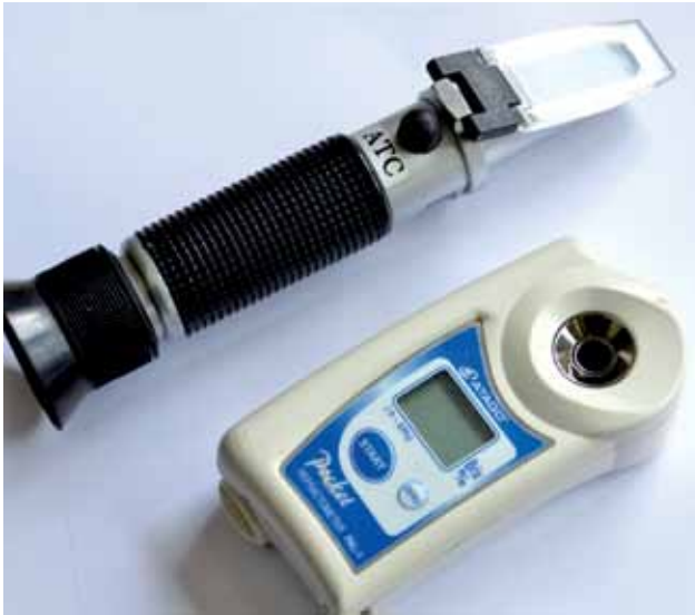
Figura 2 - Refractómetro óptico (arriba) y digital (abajo).
