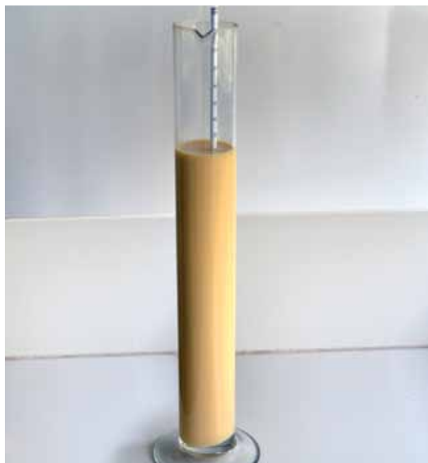
Figura 1 - Densímetro sumergido en una probeta que contiene calostro, como método de evaluación de su calidad.
