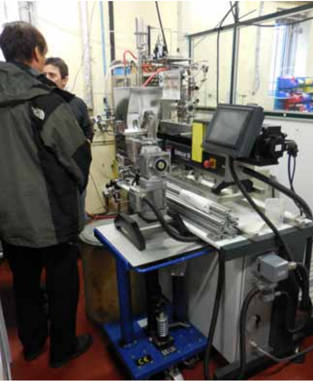
Figura 1 - Extrusor para optimización de procesos en el laboratorio del Institut National des Sciences Appliquées (Toulouse, Francia).
