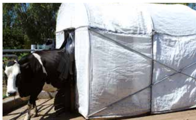
Figura 1 - Vista lateral de la trampa de paso. Se puede observar los cierres uniendo los tres compartimentos.
