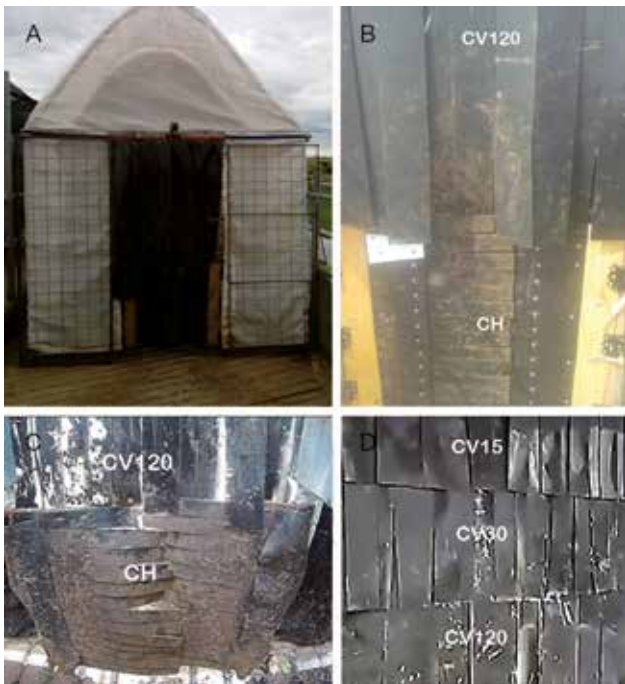
Figura 3 - Salida de la trampa (A). En B se observa la vista posterior de las cortinas verticales de 120 cm (CV120) y las cortinas horizontales (CH). En C se observa la vista anterior de las cortinas horizontales (CH) y la parte distal de las cortinas verticales de 120 cm (CV120). En D se observan, desde el lado interno superior de la trampa, las cortinas verticales de 15 cm (CV15), 30 cm (CV30) y 120 cm (CV120).
