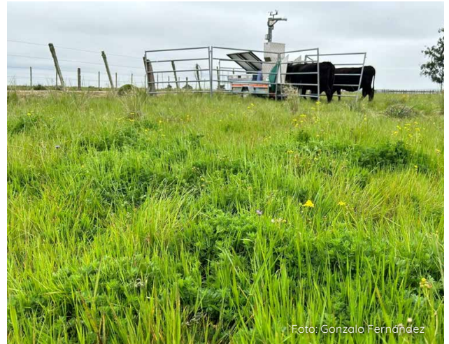
Figura 3 - Sistema GreenFeed para registro de emisiones de metano ubicado en potrero de campo natural mejorado con Lotus subbiflorus cv. El Rincón.
