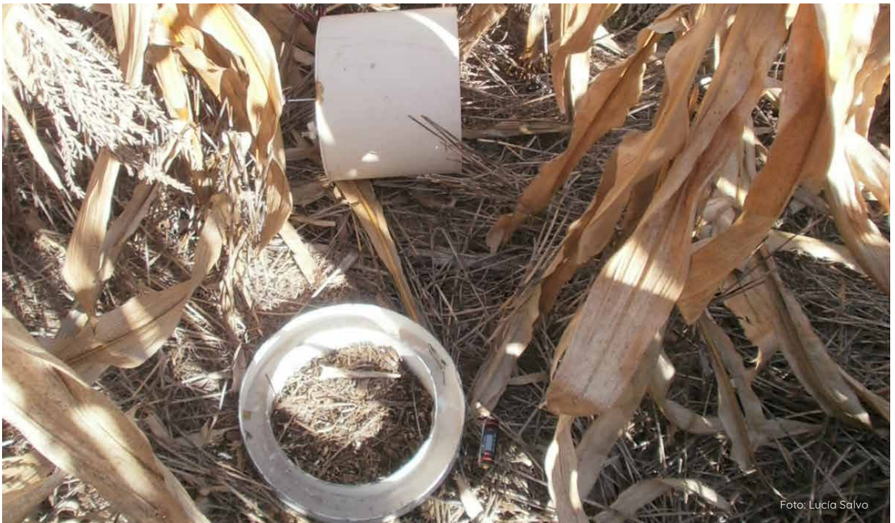
Figura 5 - Cámaras de flujo de N_2O instaladas en la EEMAC.
