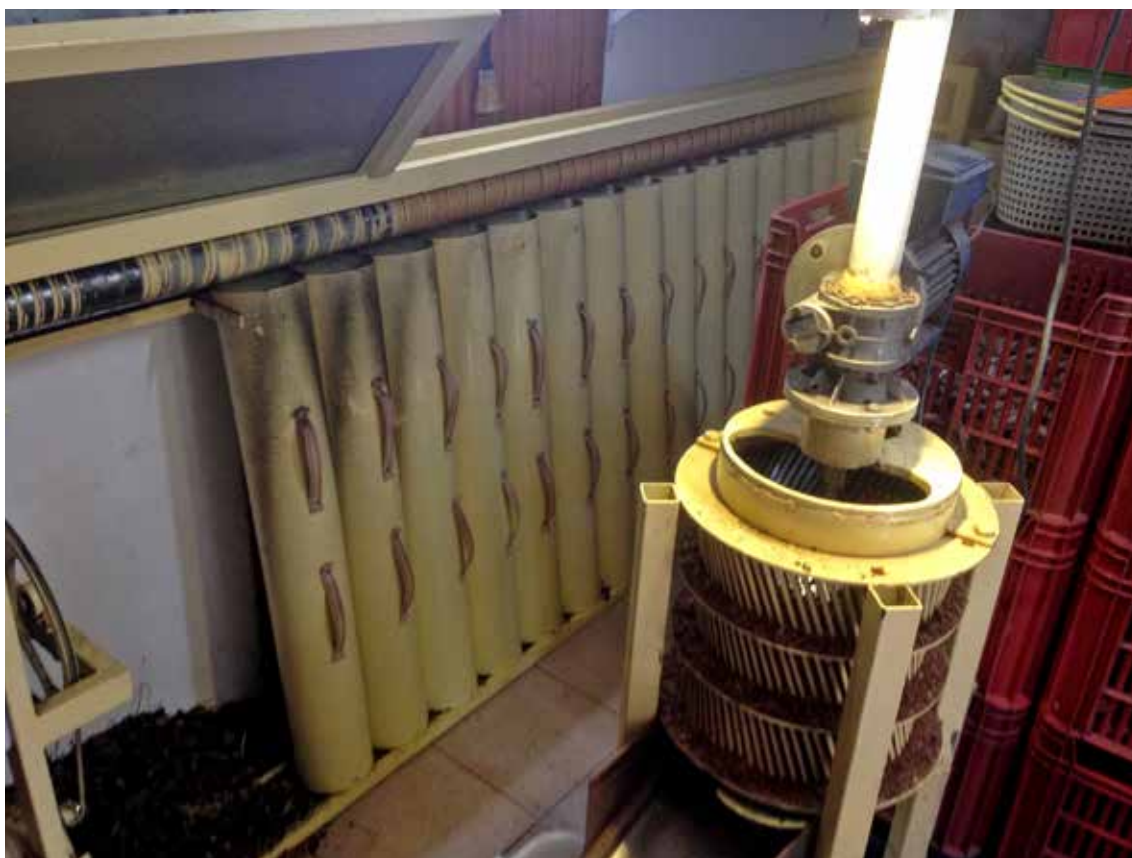
Figura 3. Máquina de processamento para classificação por tamanho (ao fundo), quebra e descascamento de nozes (à frente), fabricada em Salto, Uruguai.
